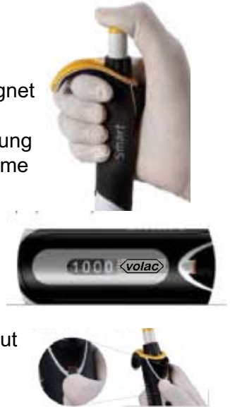
volac Mikroliterpipette mit fest eingestelltem Volumen
